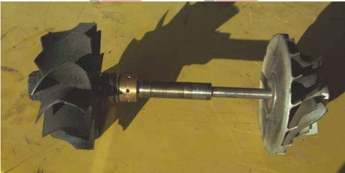
En el cuerpo del compresor, el aire entra por el centro de la carcasa dirigido directamente al rodete de álabes, que le dan un giro de 90° y lo impulsan hacia el difusor a través de un paso estrecho que queda entre la tapa, el cuerpo central y la pared interna del difusor. Este es un pasaje circular formado en la carcasa, que hace dar una vuelta completa al aire comprimido para que salga tangencialmente hacia el colector de admisión.
